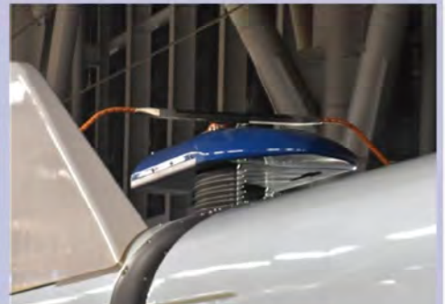
写真左は東京側の先頭車両・1号車。写真中は1号車に描かれたロゴマーク。写真右は低騒音のパンタグラフ。JR 東日本のプレスリリースによると、地震発生時により早く止まれる、屋根に取り付けた「空力抵抗板ユニット」や、車両を脱線しにくくする「地震対策ダンパ」、走行時の揺れを抑える性能、さらには着雪しにくい車体構造など、多岐にわたる項目についてチェックします。
