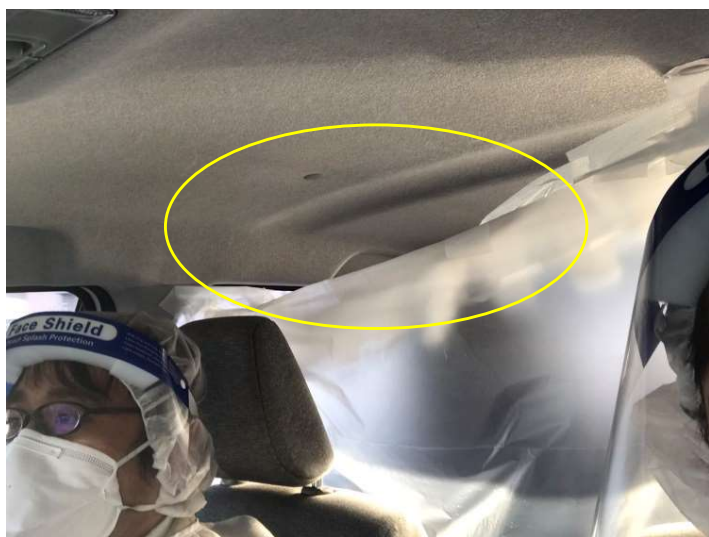
写真2. 搬送中に剥がれたビニールシート
